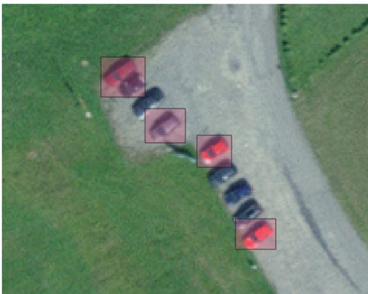
**Figure 33: Détection de véhicules. Résolution à 25cm, seuil de confiance à 0.2**
