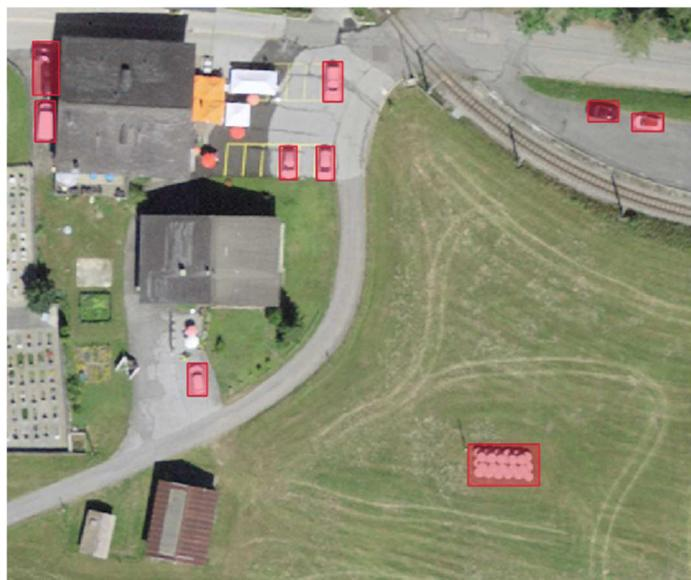
**Figure 31: détection automatique de véhicules, exemple de résultats**
