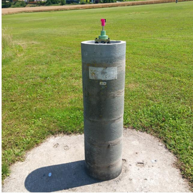
FIGURE 4.1 – Pilier géodésique utilisé pour effectuer les mesures statiques
