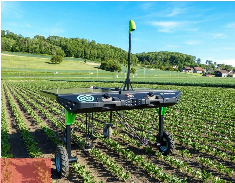
Fig. I.D4 : Robot autonome de désherbage.
