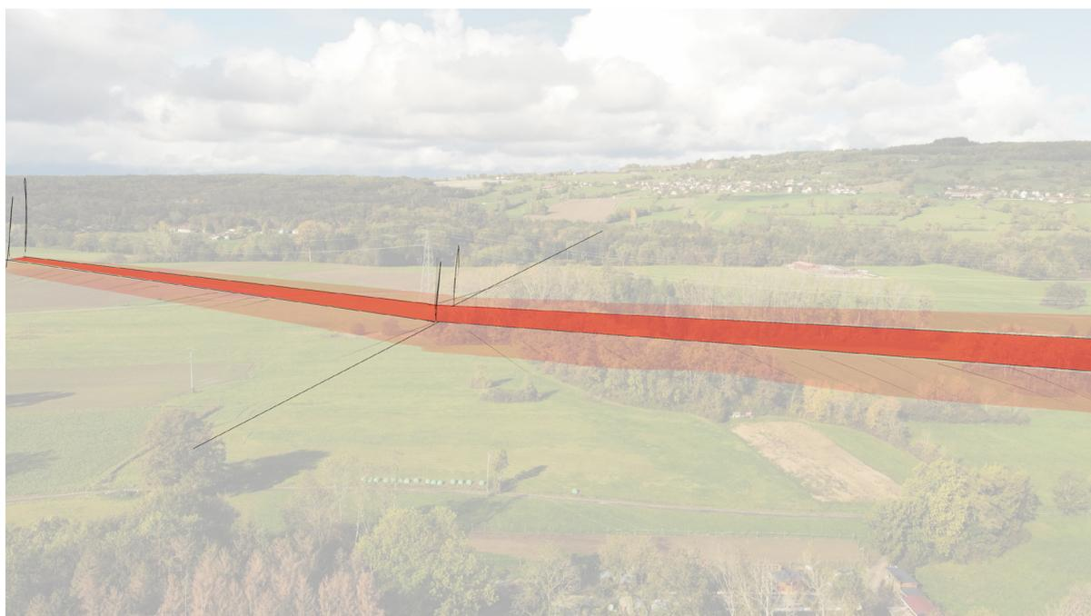
Figure 75 : passage du tracé dans le paysage, rouge foncé le tracé final et rouge clair l'emprise de construction/terrassement
