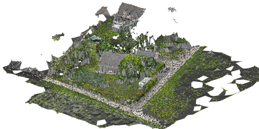
FIGURE 29 – Maillage issu d'un nuage de points
