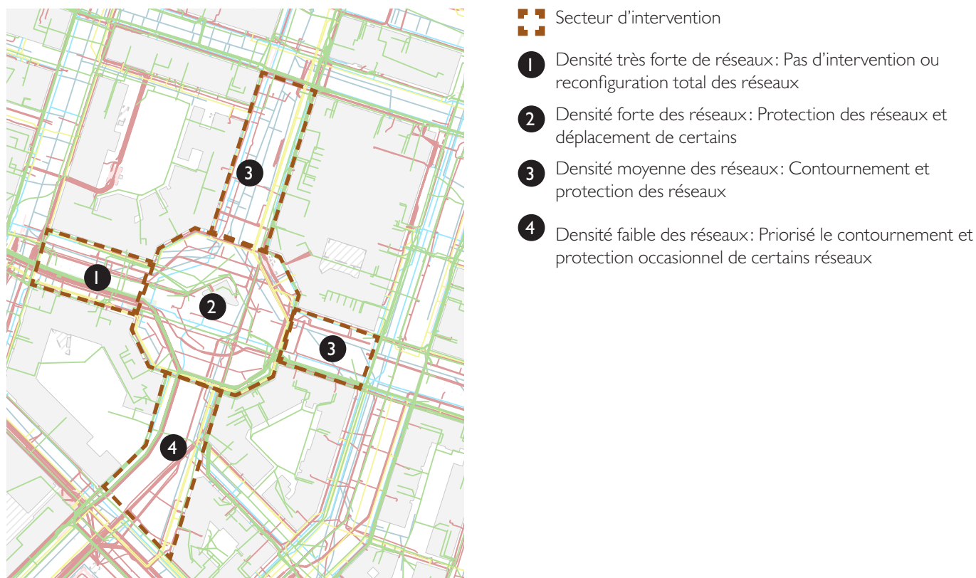
Fig.74 Possibilités de reconfiguration des réseaux
