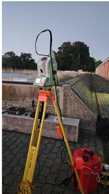
FIGURE 2.11 – Système PyDaedalus monté sur une station totale Leica TS60
