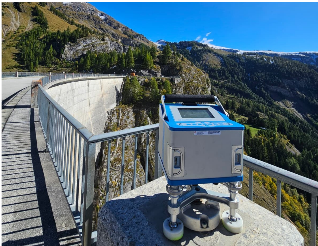
FIGURE 7.8 – Mesure gravimétrique sur le pilier n°7 (PIL 7)
