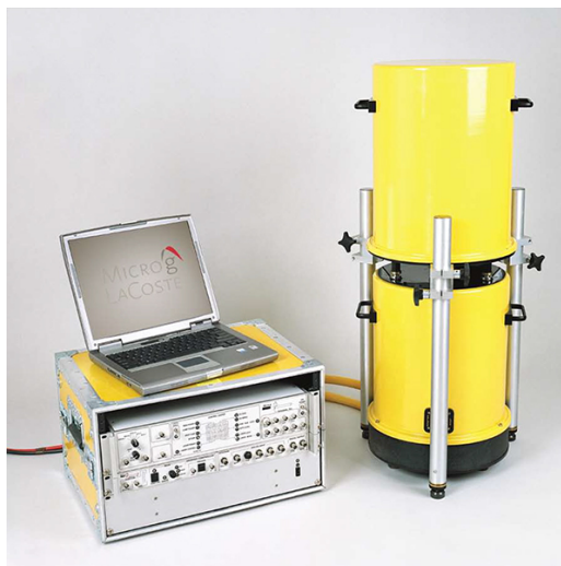
FIGURE 2.8 – Gravimètre absolu A10 Micro-g LaCoste (Scintrex). Source de l'image : (« A10 Outdoor Absolute Gravimeter », 2017)
