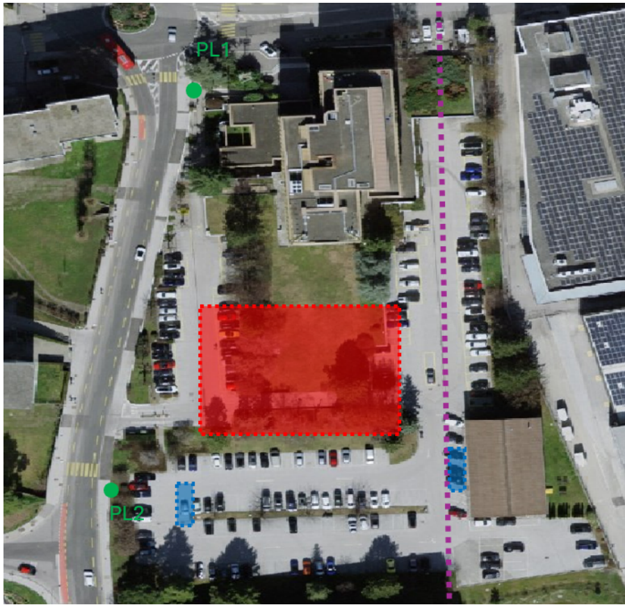
FIGURE 5.2 – Situation avec l’emplacement approximatif des points de référence (vert), le bâtiment (rouge), le mobilier urbain (bleu) et la liaison câblée (mauve).
