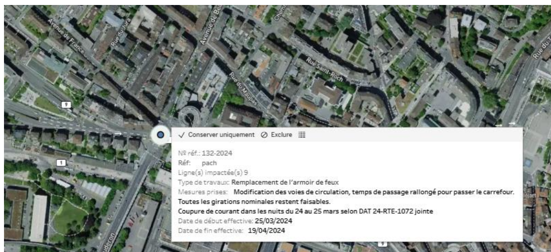
Figure 22 : Exemple de fiche chantier (Source : TL)
