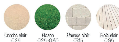
Fig. 12. L'albédo est le pouvoir réfléchissant d'une matière. De manière générale, les revêtements «foncés» accumulent la chaleur et ont un albédo faible. (Production des auteurs, 2020)
