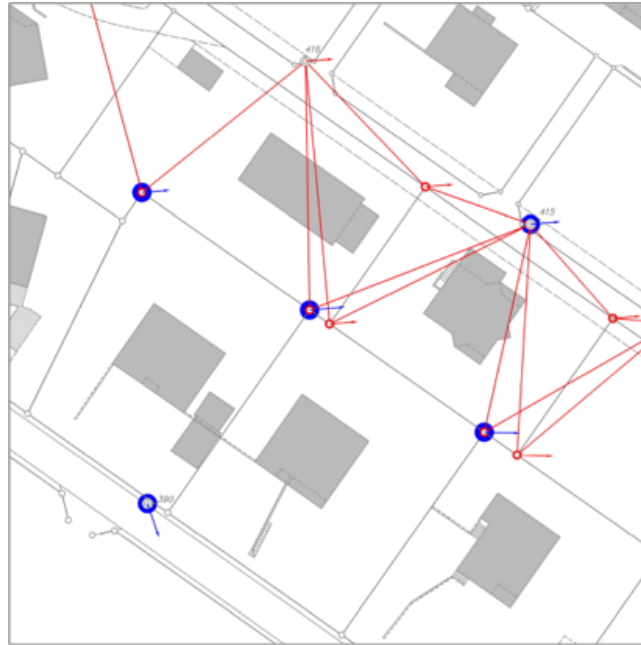
FIGURE 4.13 – Filtrage des observations fictives pour la compensation finale
